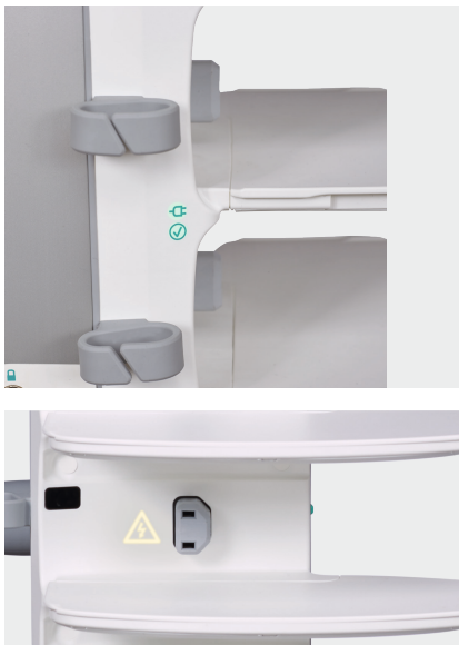
Figure 5: LED dioda napájení ze sítě a stavová LED dioda na boční straně (nahore) a výstražná kontrolka napájení sítě v přihrádce pumpy (dole) stanice Space plus Station.
